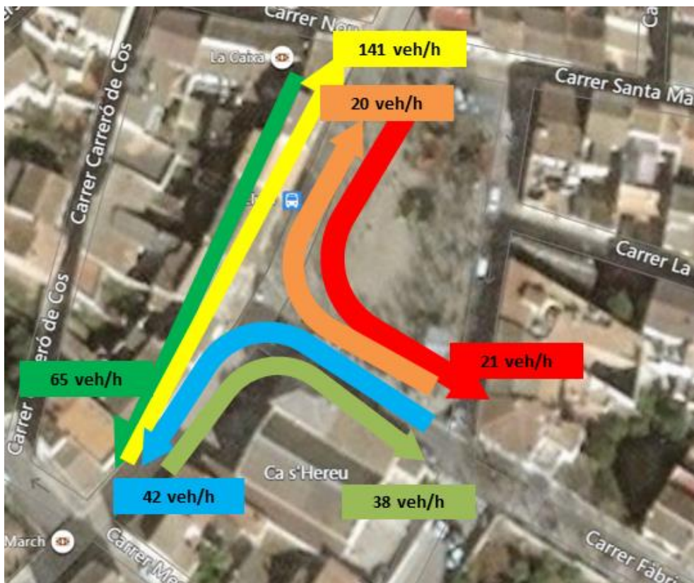
Fig. 28. Intensitat en Hora Punta (IHP) de 18:00 a 19:00 al punt B en dia feiner
